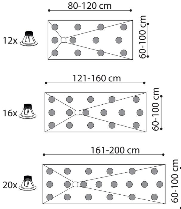
**Type de support d'élévation conseillé**
